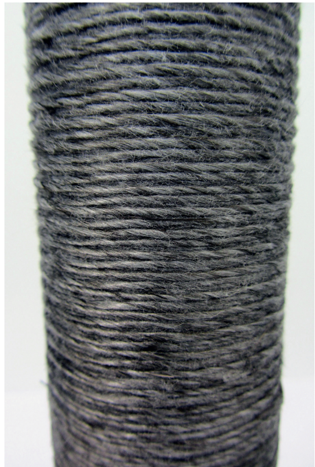
Abb. 4: Hybridgarn mit Faservolumenanteil von 50% rCF (Quelle: TU Dresden).
