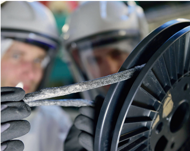
Abb. 1: Stapelfaserband aus 100% rCF (Quelle: STFI e.V.).
