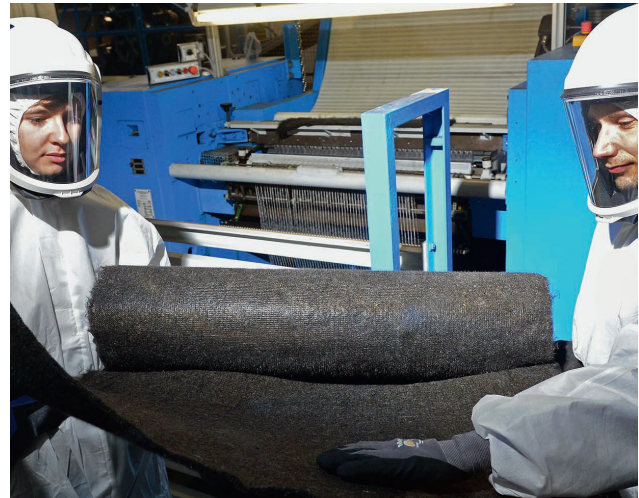
Abb. 2: Nadelvliesstoff aus 100% rCF (Quelle: STFI e.V.).
